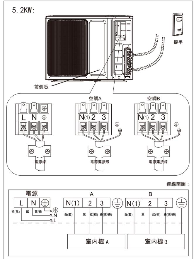
⚠ 本機不帶插頭，在固定線路中必須加一個斷路器，該斷路器是全極斷開，並且觸點開斷距離至少為3mm。
