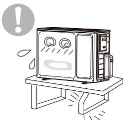
若底座損壞不加修理, 機體可能掉落, 造成傷害。
