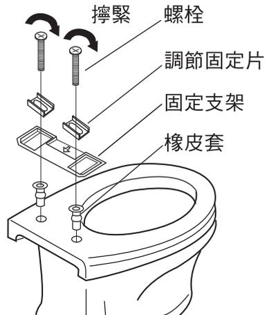
※ 固定支架的螺栓節距在130mm-170mm的範圍內可調節。
