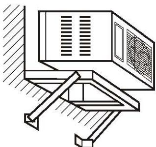
固定安裝架時，請調整角度，使後部有3~5度之傾斜，以利排水。
