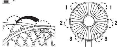
最後將下方網扣固定器扣上，並鎖上螺絲即可。
