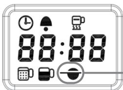
咖啡粉圖示閃亮，表示機器正在悶煮咖啡，圖示將閃爍持續到悶煮程序完成。
