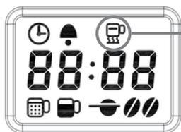
保溫狀態符號，在此狀態下，咖啡機設定將在煮咖啡完成後30分鐘內自動斷電（從聽到嗶嗶響聲音後開始計時）
