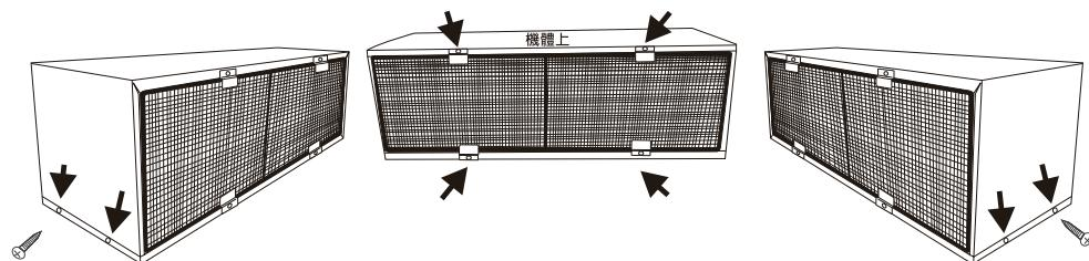
”箭頭處螺絲”拆下(2.8kw圖式)共有8顆螺絲需拆下
