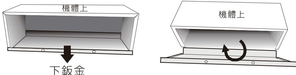
圖下方”下鈑金”取出,並順勢往上扣住風箱。(寬面在下方)
