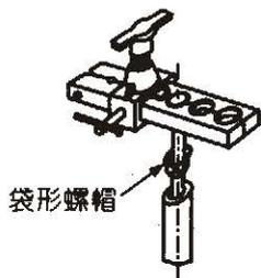
擴管前須先將銅管毛邊削除，用活動扳手取下二方閥或三方閥上之袋形螺帽，放入銅管以進行擴管工作。
